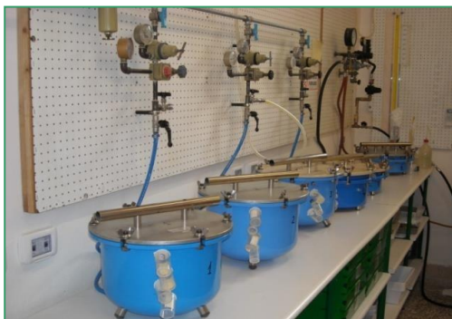
Fig.2 Minitensiometri per la misura del potenziale matriciale dell'acqua nel suolo e piastre di Richards per la determinazione della curva di ritenzione dei suoli
