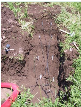
Fig.2 Minitensiometri per la misura del potenziale matriciale dell'acqua nel suolo e piastre di Richards per la determinazione della curva di ritenzione dei suoli
