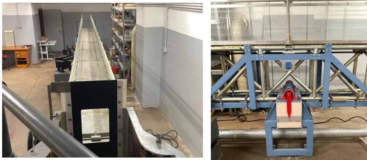
Fig.7 Vista del canale a pendenza variabile
