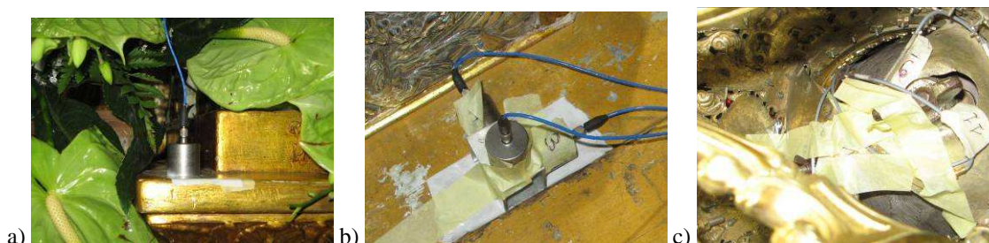
Figura 8. a) sensore posto sul fercolo; b) terna di sensori sismici sulla base; c) terna di sensori miniaturizzati sulla testa.
