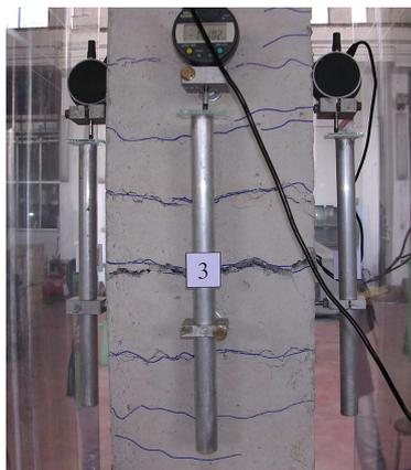
Figura 9: Fessurazione della regione tesa della colonna.
