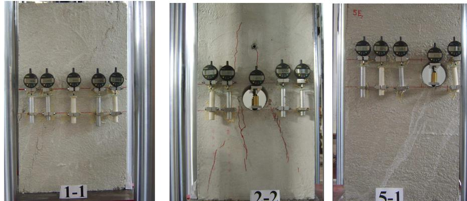
Figura 4 : Provini strumentati in prossimità del foro.
