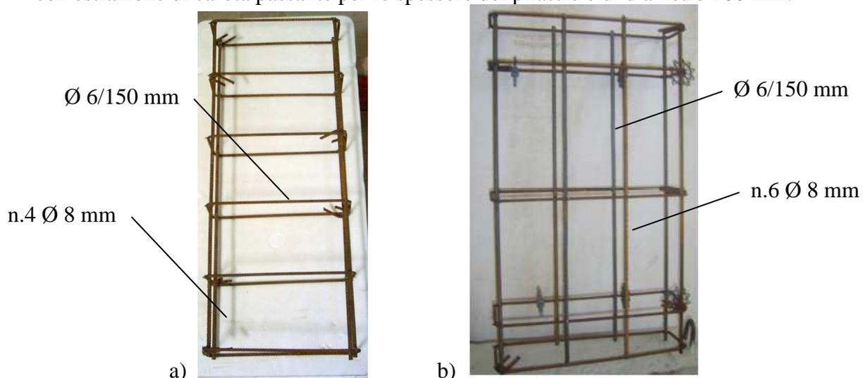
Figura 2 : Disposizione armature e confezionamento provini a) prima serie; b) seconda serie.
