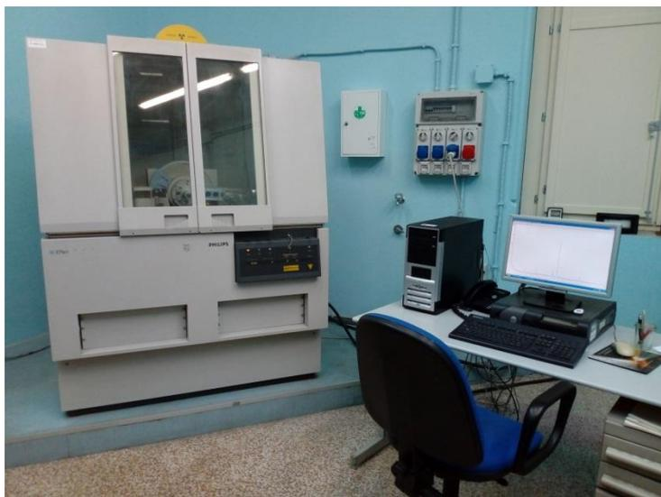
La Diffrazione a Raggi X (XRD) è una delle metodologie più antiche della scienza moderna e tra le più utilizzate per l'analisi di campioni di diversa natura prevalentemente nel campo geologico/ambientale e tecnologico. Viene utilizzata per l'identificazione, lo studio e la stima semiquantitativa dei minerali presenti in materiali solidi naturali ed artificiali (rocce, sedimenti, suoli, malte, ceramici).
