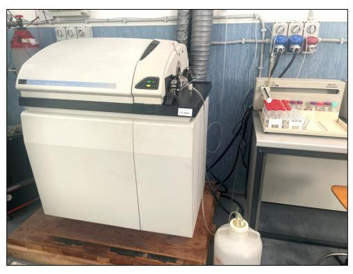
Il Laboratorio ICP-MS esegue analisi multi-elementari per la determinazione quantitativa della maggior parte degli elementi della tavola periodica, rilevabili in concentrazioni fino all'ordine di ppm (parti per milione), ppb (parti per miliardo) e ppt (parti per trilione). Le analisi possono essere condotte su campioni appartenenti a matrici complesse, sia organiche che inorganiche, tra cui rocce, suoli, sedimenti, lisciviati, acque e materiali vegetali.
